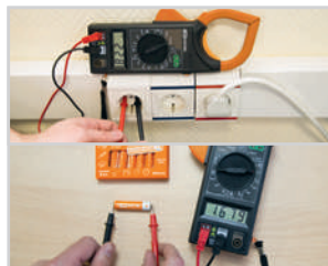
Измерение постоянного и переменного напряжения и тока.
