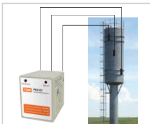
Автоматический контроль уровня воды в водонапорной башне.
