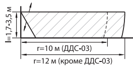
ДДС Зона обнаружения по вертикали (вид сбоку)
