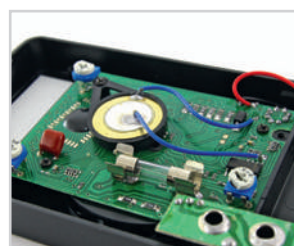
Мультиметры защищены от перегрузок по току с помощью предохранителя 250 мА/250 В.
