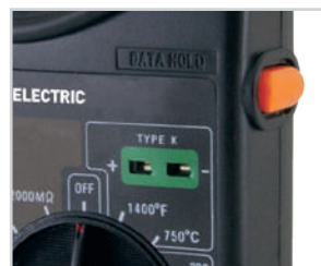
Клещи оснащены кнопкой «DATA HOLD», которая записывает измеряемые показания.
