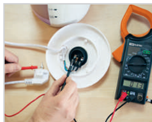
Измерение напряжения в цепи. Проверка целостности цепей.
